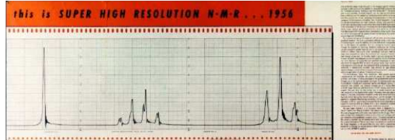
FIG. 1.3: Extrait d'un article présentant un spectre RMN « super haute-résolution » acquis en 1956 sur un échantillon d'éthanol.
