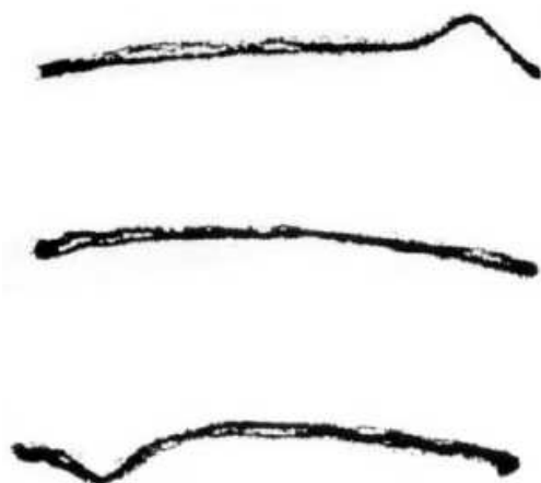
FIG. 1.1: Premiers signaux RMN expérimentaux acquis en 1946 sur un échantillon d'eau avec un champ de 0.2 T.
